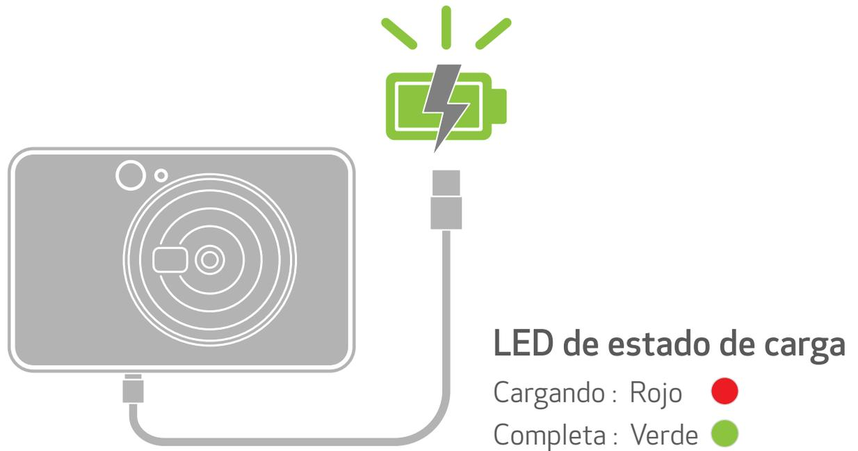
El dispositivo incluye una batería incorporada. Antes de usar, cargue completamente el dispositivo con el cable USB proporcionado.
